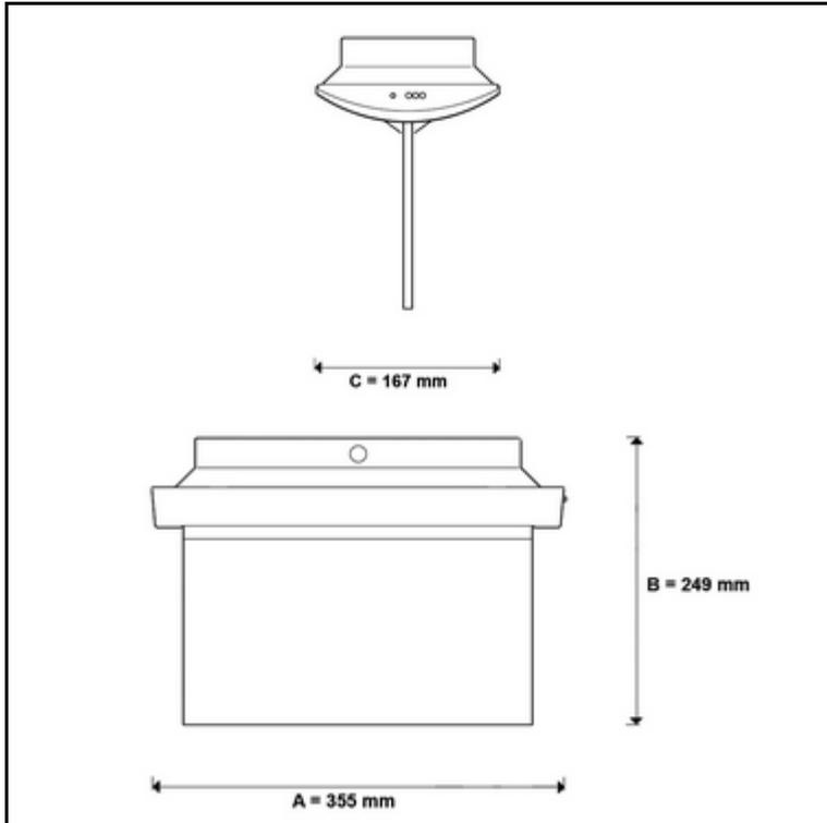
Rettszeichenleuchte mit beidseitiger Piktogrammscheibe in exklusivem Design, als Notleuchte gemäß DIN EN 60598-1, DIN EN 60598-2-22 und DIN EN 1838 für Anlagen gemäß DIN VDE 0108 / 10.89 für zentrale Versorgung.
