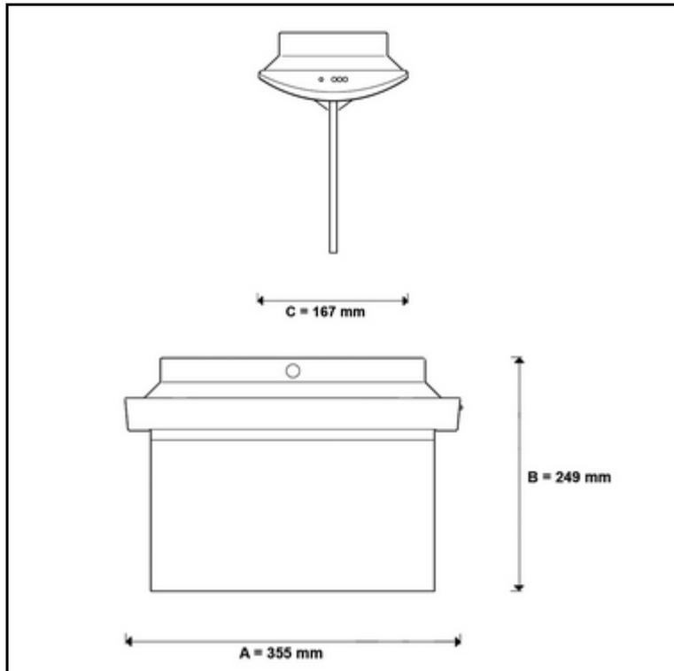
Rettungszeichenleuchte mit beidseitiger Piktogrammscheibe in exklusivem Design, als Einzelbatterie-Notleuchte mit AUTOTEST-Funktion gemäß DIN EN 60598-1, DIN EN 60598-2-22 und DIN EN 1838 für Anlagen gemäß DIN VDE 0108 / 10.89 zum separaten Betrieb.
