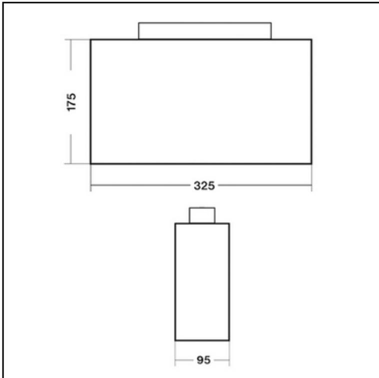
Exklusive Sicherheits- und Rettungszeichenleuchte in Aluminiumprofilrahmen mit High-Power-LED's, als Notleuchte gemäß DIN EN 60598-1, DIN EN 60598-2-22 und DIN EN 1838 für Anlagen gemäß DIN VDE 0108 / 10.89, für zentrale Versorgung.
