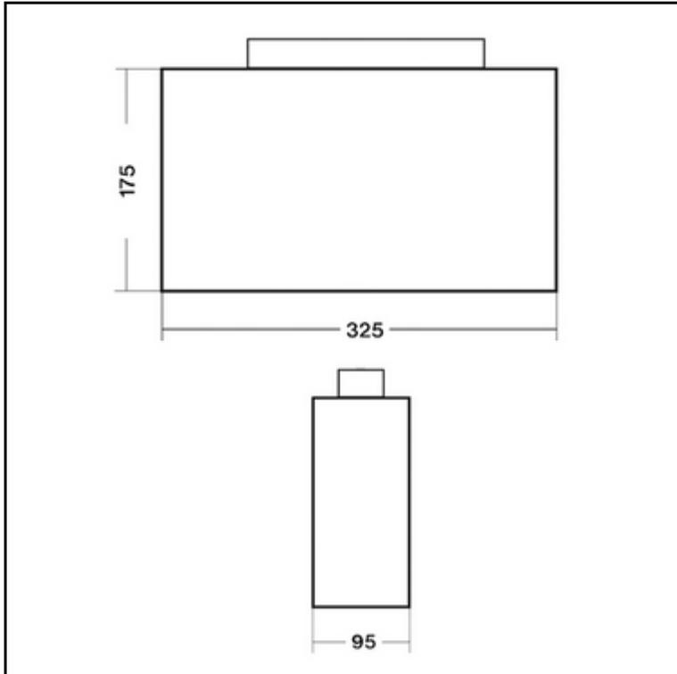
Exklusive Sicherheits- und Rettungszeichenleuchte in Aluminiumprofilrahmen mit High-Power-LED's, als Einzelbatterie-Notleuchte mit AUTOTEST-Funktion gemäß DIN EN 60598-1, DIN EN 60598-2-22 und DIN EN 1838 für Anlagen gemäß DIN VDE 0108 / 10.89 zum separaten Betrieb.
