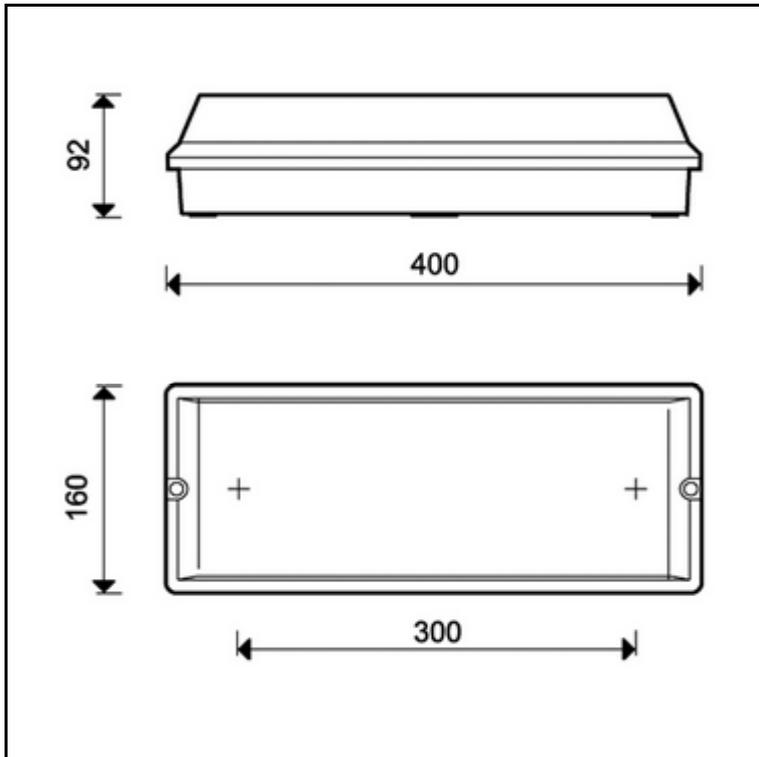
Sicherheits- und Rettungszeichenleuchte IP 65 in Standardausführung mit High-Power-LED's für den Einsatz bis -30°C, als Einzelbatterie-Notleuchte mit AUTOTEST-Funktion gemäß DIN EN 60598-1, DIN EN 60598-2-22 und DIN EN 1838 für Anlagen gemäß DIN VDE 0108 / 10.89 zum separaten Betrieb.
