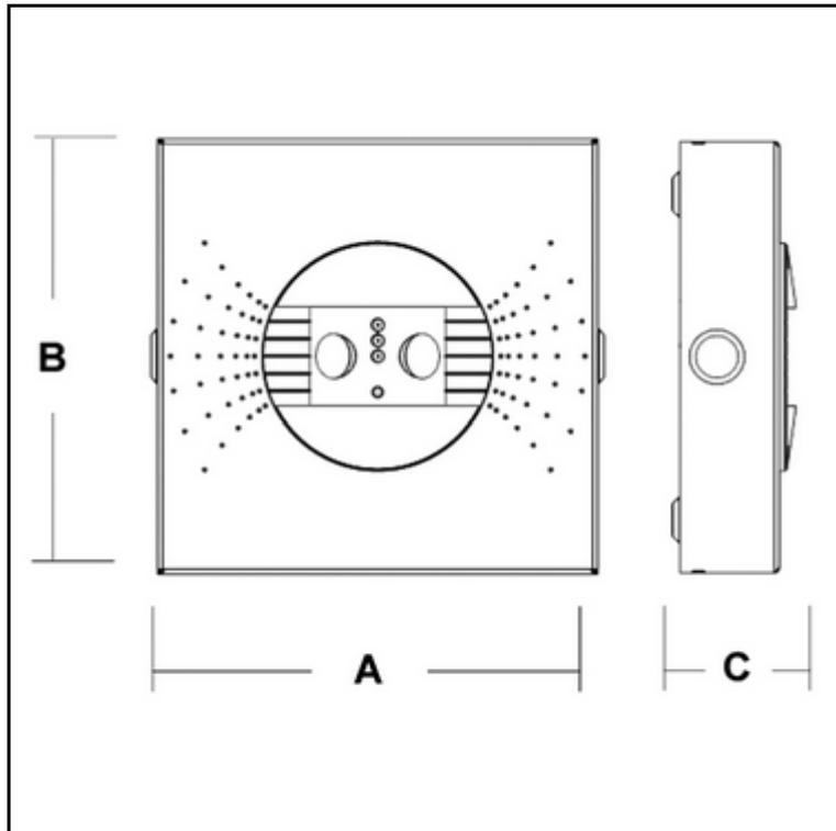
LED-Sicherheitsleuchte mit High-Power-LED's mit einer rechteckigen Abstrahlcharakteristik, Typ A, für einen maximalen Lichtpunktastand von 14,1 m, als Einzelbatterieleuchte mit AUTOTEST-Funktion gemäß DIN EN 60598-1, DIN EN 60598-2-22 und DIN EN 1838 für Anlagen gemäß DIN VDE 0108 / 10.89 zum separaten Betrieb.
