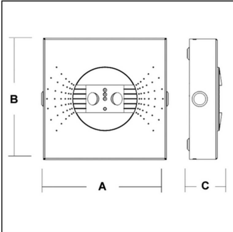
LED-Sicherheitsleuchte mit High-Power-LED's mit einer runden Abstrahlcharakteristik, Typ B, als Einzelbatterieleuchte mit AUTOTEST-Funktion gemäß DIN EN 60598-1, DIN EN 60598-2-22 und DIN EN 1838 für Anlagen gemäß DIN VDE 0108 / 10.89 zum separaten Betrieb.
