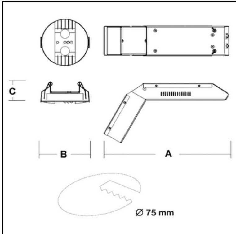
LED-Sicherheitsleuchte mit High-Power-LED's mit einer rechteckigen Abstrahlcharakteristik, Typ A, für einen maximalen Lichtpunktstand von 14,1 m, als Einzelbatterieleuchte mit AUTOTEST-Funktion gemäß DIN EN 60598-1, DIN EN 60598-2-22 und DIN EN 1838 für Anlagen gemäß DIN VDE 0108 / 10.89 zum separaten Betrieb.
