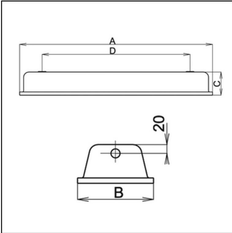
Explosiongeschützte Wand-/Deckenleuchte aus Stahlblech, für Anwendung in EX-Zone 2 und 22, als Einzelbatterie-Sicherheitsleuchte gemäß DIN EN 60598-1, DIN EN 60598-2-22 und DIN EN 1838 für Anlagen gemäß DIN VDE 0108 / 10.89 zum separaten Betrieb. Inklusive ATEX-Prüfzertifikat für die Gesamtkonstruktion.
